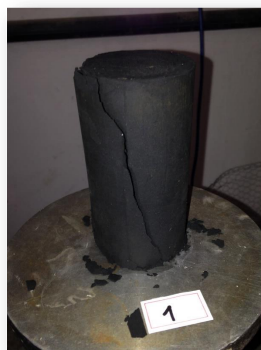
Corpo de prova após o rompimento.
