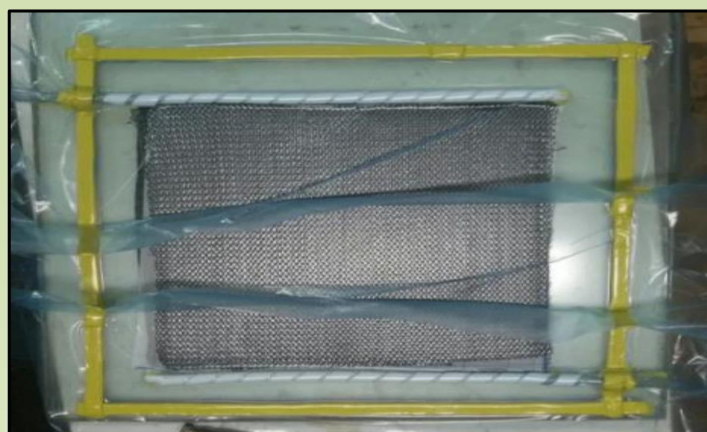
Figura 1 – Layup do processo de infusão
