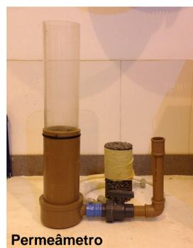
Coefficiente de permeabilidade ou condutividade hidráulica ( $k$ ): representa a velocidade com que a água percola no material completamente saturado. Permeâmetro: permite a determinação de  $k$  utilizando princípios da pressão hidrostática. Com este equipamento mede-se o tempo necessário para uma quantidade de água descer de um nível inicial para um nível final passando por uma amostra de material que se deseja saber o coeficiente de permeabilidade ( $K$ ).
