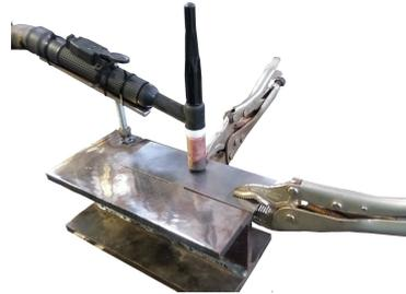
Figura 2: Dispositivo utilizado para a realização dos pontos de solda
