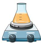
Solução de PA-6 (20% m/V) em Ácido Fórmico (agitação de 24h)
