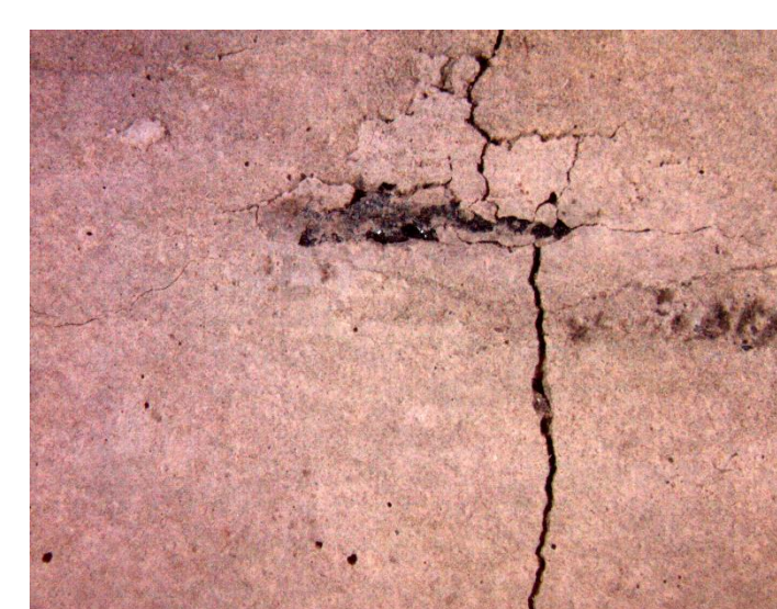
Interface espaçador de plástico-concreto com estresse térmico
