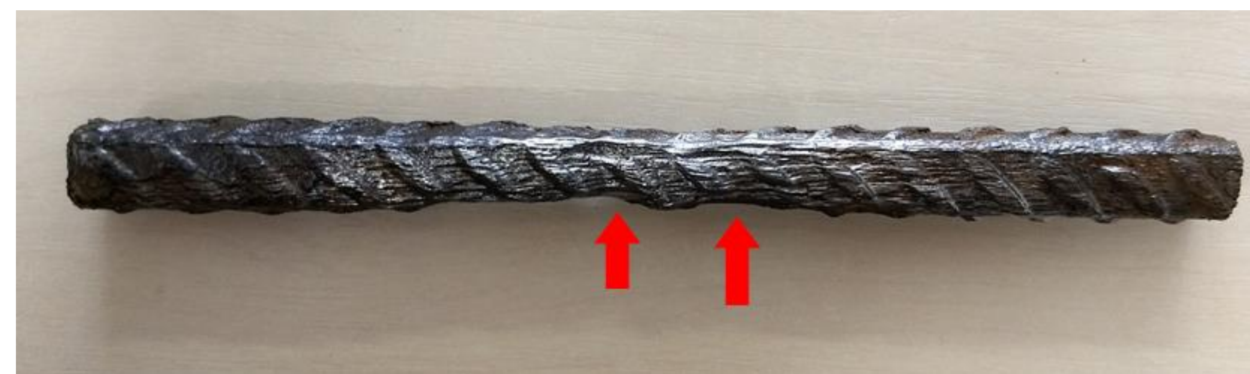
Barra após ensaio de Propagação da Corrosão
