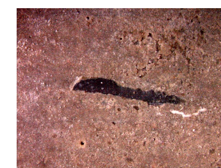
Interface espaçador de plástico-concreto sem estresse térmico
