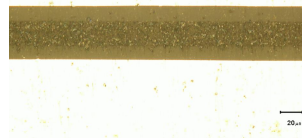
Figura 1: cross section da amostra de H 2 SO 4 0,5M com densidade de corrente de 5 mA/mm 2 por 90 minutos
