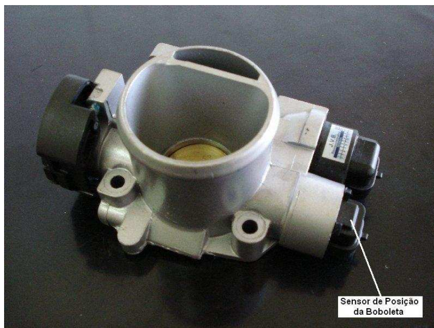
Figura 3.8: Sensor de posição acoplado ao corpo de borboleta
