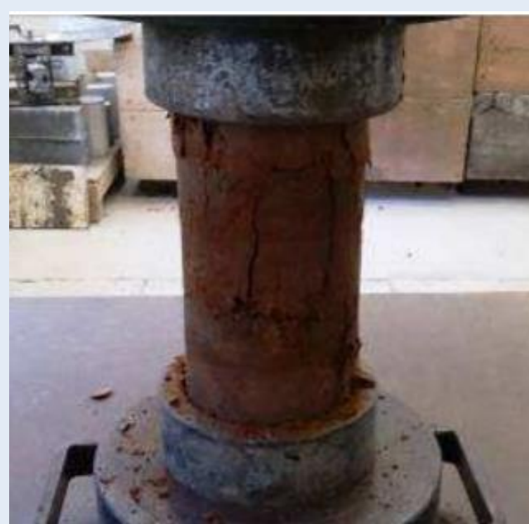
Moldagem e ensaio de RCS
