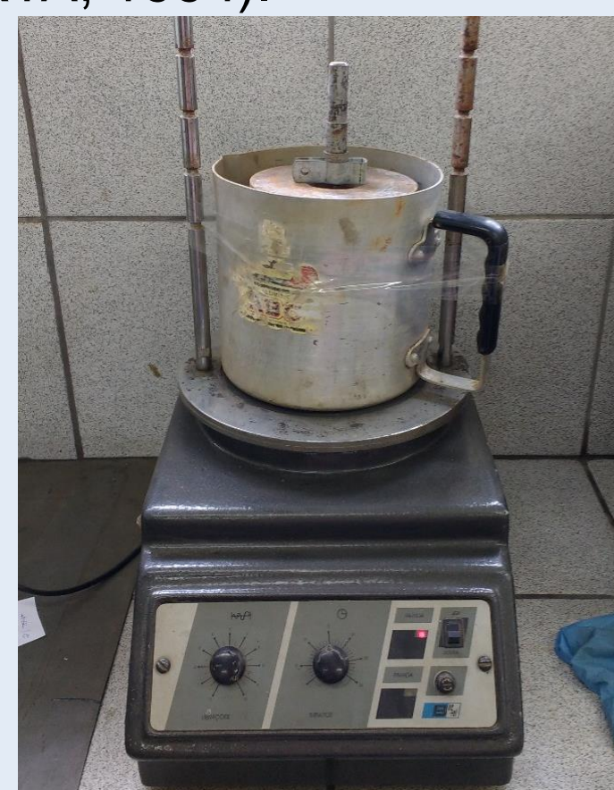
Ensaio de erodibilidade: exposição à lâmina d'água e vibração
