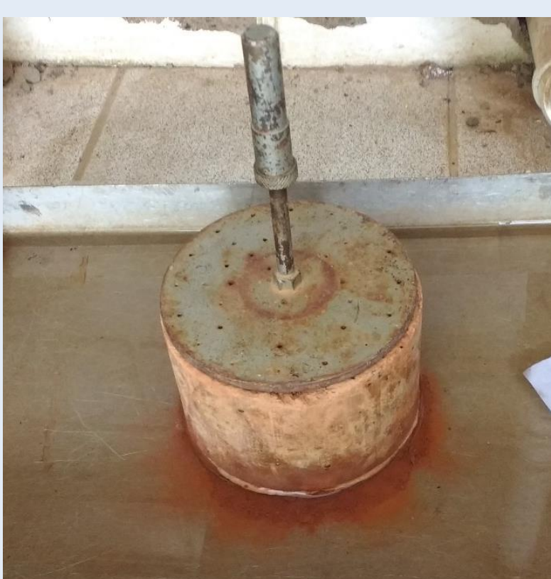
Ensaio de erodibilidade: exposição à lâmina d'água e vibração
