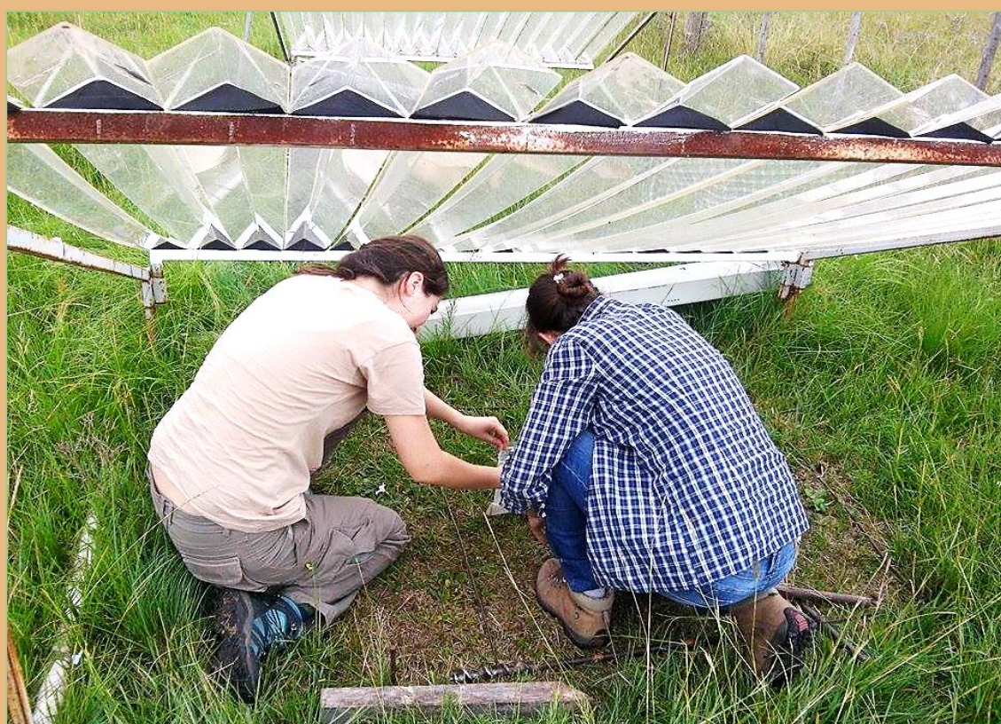
Figura 1: A manipulação dos regimes de chuva ocorre através de interceptadores construídos com calhas de acrílico com dimensões de 2 x 2 m. Instalação das armadilhas pitfall na parcela.
