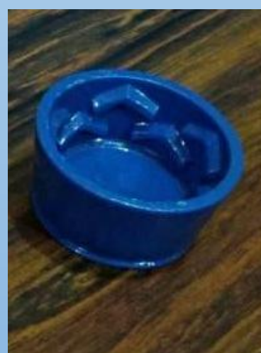
Figura 3 – Molde em miniatura do inibidor de turbulência novo (circular).
