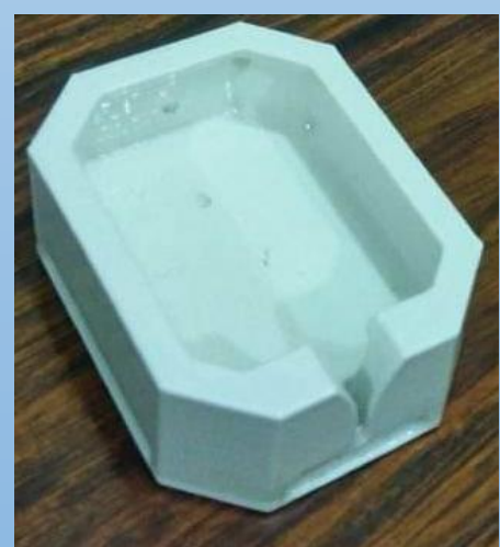
Figura 2 – Molde em miniatura do inibidor de turbulência antigo (octogonal retangular).
