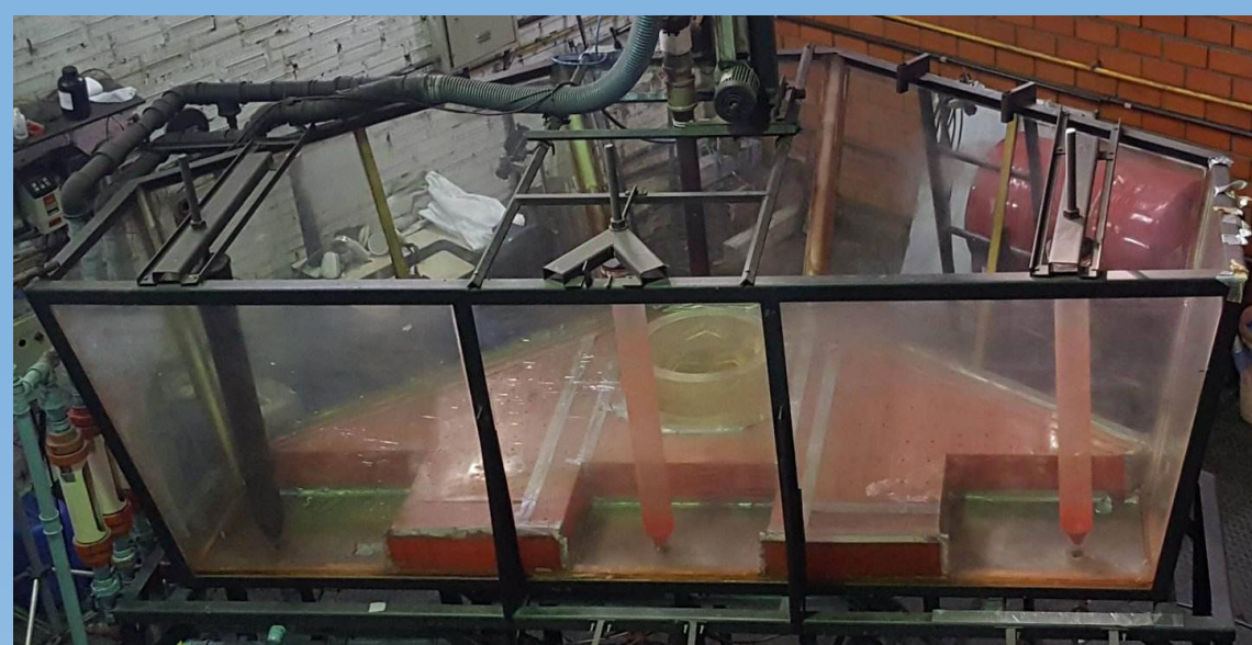
Figura 1 – Modelo físico do distribuidor de lingotamento contínuo tipo Delta localizado no LaSid
