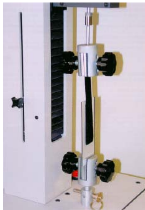
Figura 3.2. Equipamento utilizado para teste de Peel Adhesion
