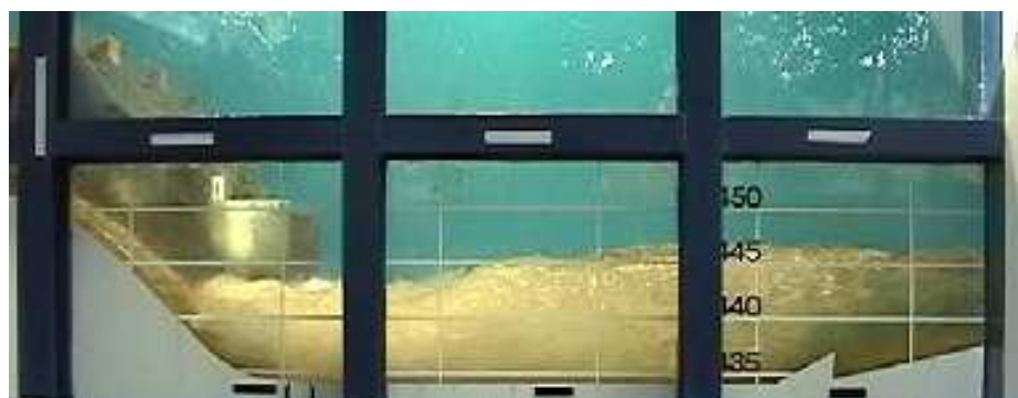
Figura 4.7 - Ressalto hidráulico formado no modelo 1:50 para a vazão equivalente ao protótipo de 4000 m 3 /s.
