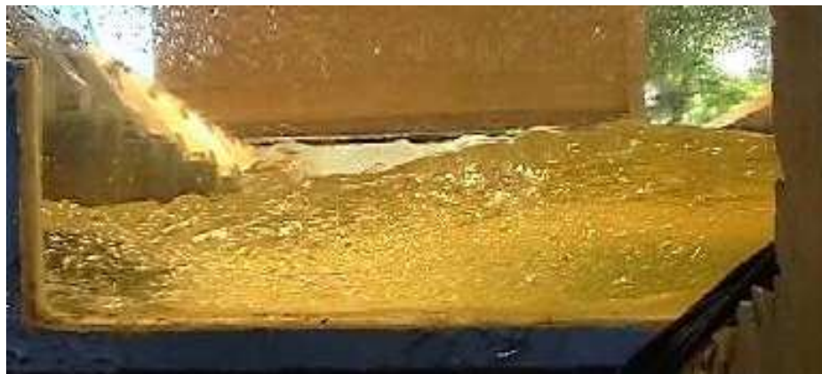
Figura 4.5 - Ressalto hidráulico formado no modelo 1:100 para a vazão equivalente ao protótipo de 4000 m 3 /s.
