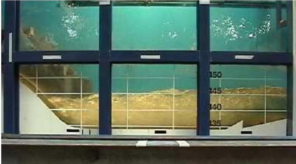
Figura 3.2 - Ressalto hidráulico formado no modelo reduzido da UHE Porto Colômbia (escala 1:50), vazão de 4000 m 3 /s.
