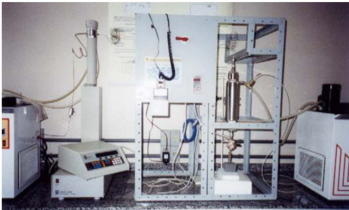
Fotografia 1 - Unidade em escala de laboratório que consiste basicamente de um cilindro de CO 2 , dois banhos termostáticos (Quimis), uma bomba de alta pressão (ISCO 260D), um reator em aço inoxidável (200 mL), um transdutor (Smar, LD301), equipado com um sistema para aquisição de dados (Smar, HT 201) com uma precisão de \pm 0,012 MPa e um tubo coletor de vidro.
