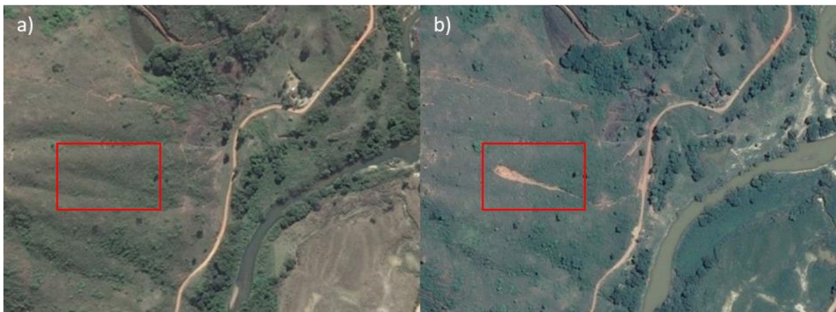
Figura 6-18: Movimento de massa numa encosta próximo ao rio Pancas, afluente do rio Doce. a) imagem do dia 18 de julho de 2013 e b) imagem do dia 05 de maio de 2014. Fonte: Google Earth.
