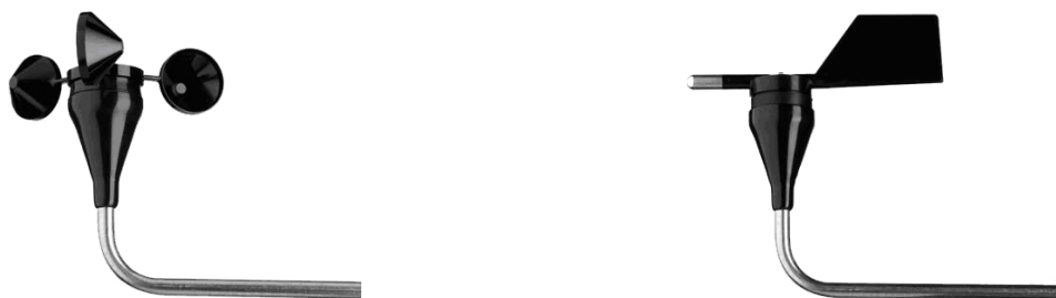
Figura A4.5. a) Anemômetro de conchas modelo NGR#40, b) Veleta modelo NGR#200, utilizados no sistema experimental (Fonte: NGR, 2006).
