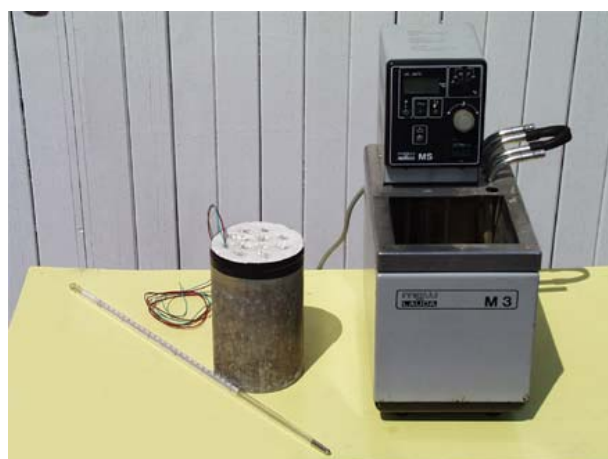
Figura A4.3. Foto do banho termostático MGM Lauda M3 junto com um termômetro de mercúrio utilizado na calibração dos sensores de temperatura.
