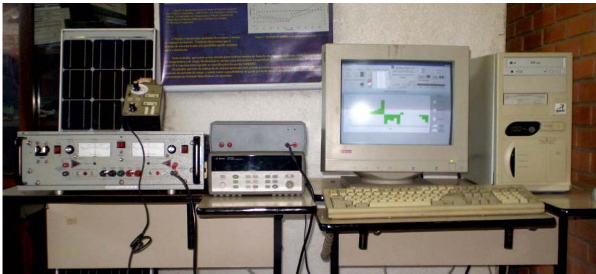
Figura 4.7 Alguns dos elementos utilizados para desenvolver o sistema de caracterização de baterias e computador que na tela do monitor apresenta o entorno gráfico do programa para controlar os ensaios.
