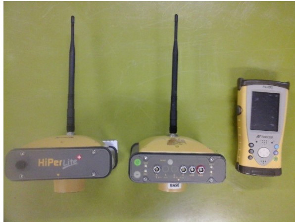
Figura 16 - Receptores GNSS e Coletora.
