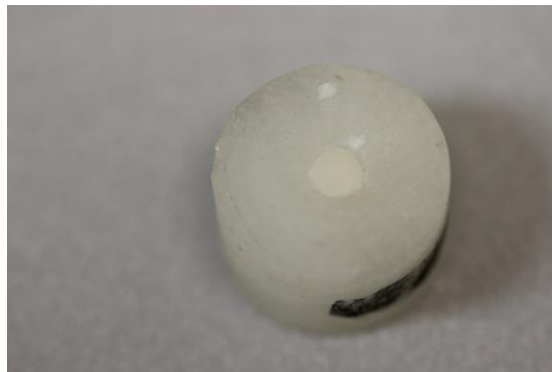
Figura 2 – Corpo de prova estabilizado em resina acrílica incolor
