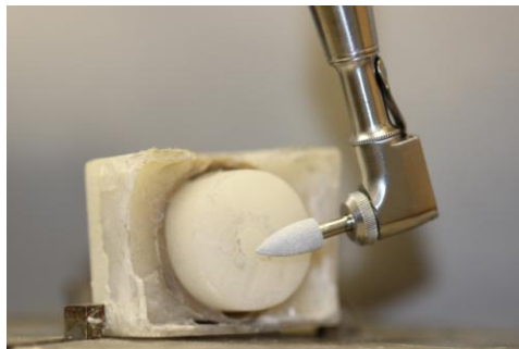
Figura 3 – Processo de acabamento e polimento em dispositivo fixo
