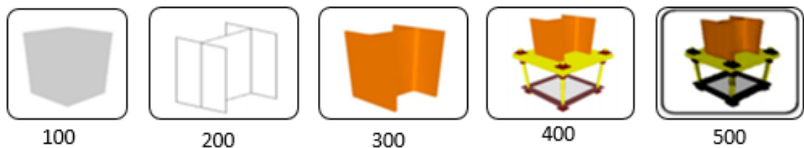
Figura 8 – Representação esquemática do LOD (Fonte: adaptado de BIMFORUM (2015))
