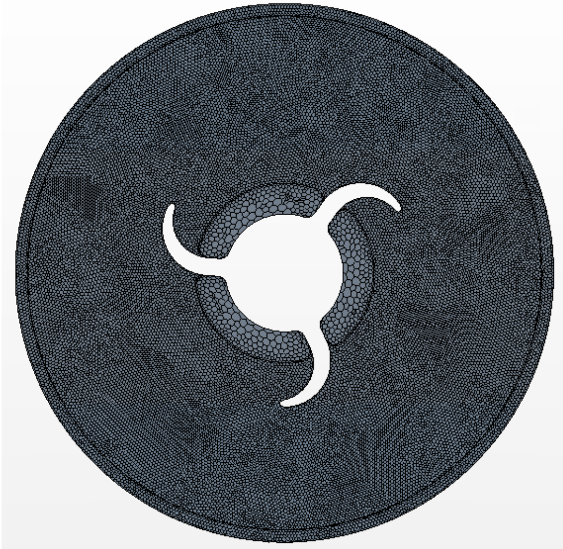
Figura 4.8 – Malha plano XY elementos poliédricos nas faces de um disco da turbina.
