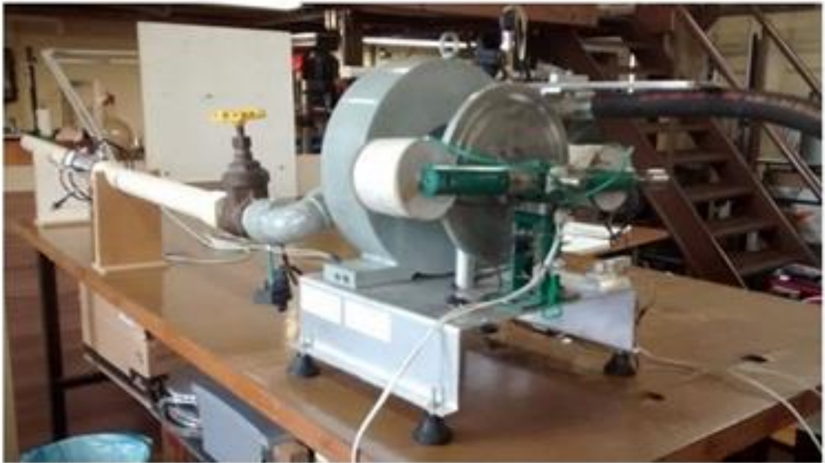
Figura 2.3 – Bancada de ensaios experimentais da turbina Tesla presente no laboratório de ensaios termodinâmicos e aerodinâmicos da UFRGS.
