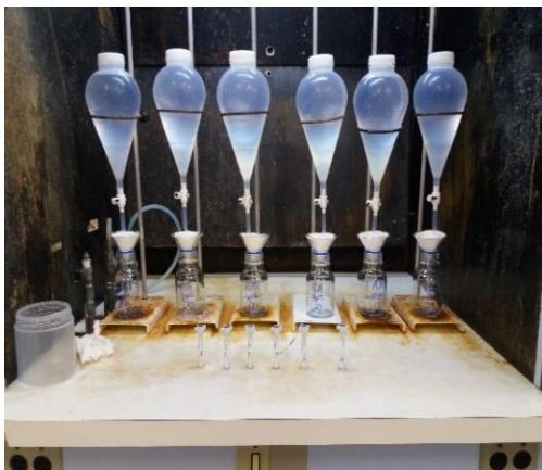
Figura 5. Extração em fase líquida para análise de recuperação da validação.
