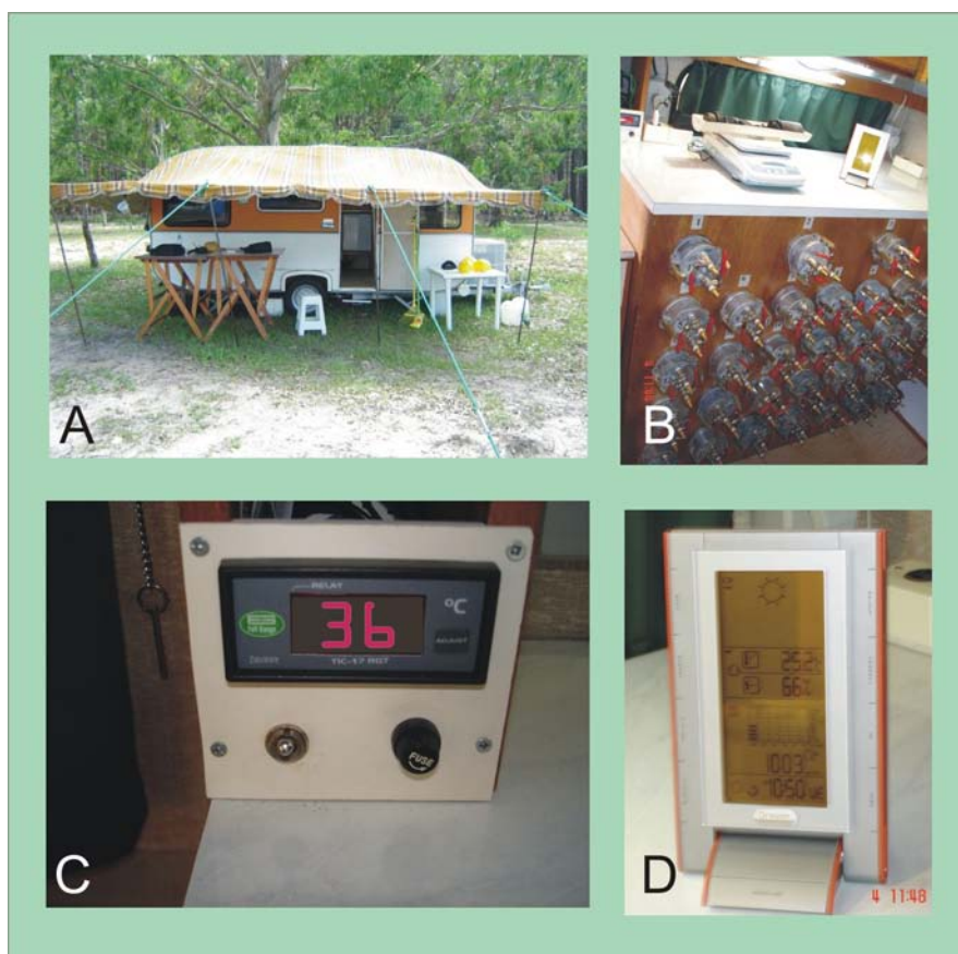
Figura 13. A) laboratório móvel; B) bancada para armazenamento das amostras de carvão visando obtenção da estimativa de geração de metano; C) termômetro acoplado para controle de temperatura interna da caixa que contém as amostras, simulando a temperatura do reservatório (36°C na profundidade de 600 m); D) aparelho para monitoramento de temperatura ambiente e pressão no momento da medição do gás.
