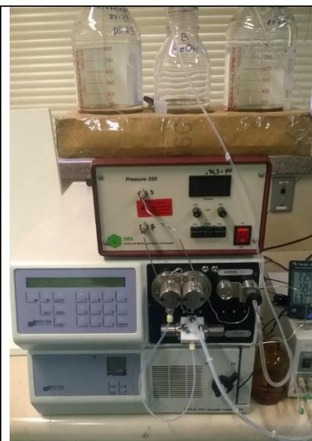
*Figura 5 - Equipamento de HPLC do Laboratório de Métodos, modelo 525 System da Biotech.*
