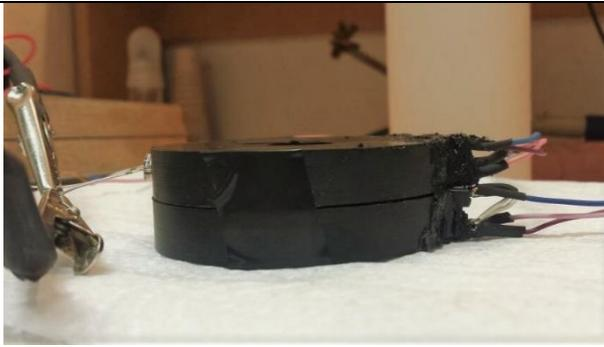
*Figura 21 – Vista lateral do detector. Na esquerda pode ser visto o LED, e na direita os dois fotodiodos OPT101..*
