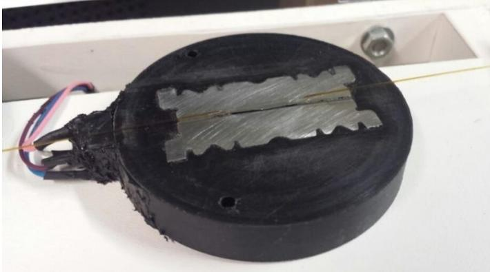
*Figura 22 - Posicionamento do capilar sobre a parte inferior do detector.*
