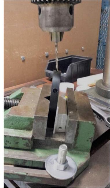
*Figura 20 - Usinagem em ângulo da peça para posicionamento do LED.*
