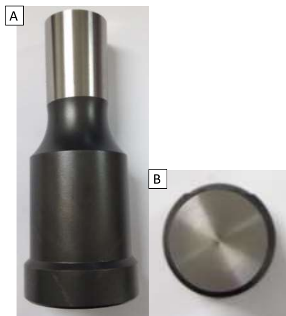
Figura 13 - Punção de corte convencional, a) vista lateral e b) vista superior.
