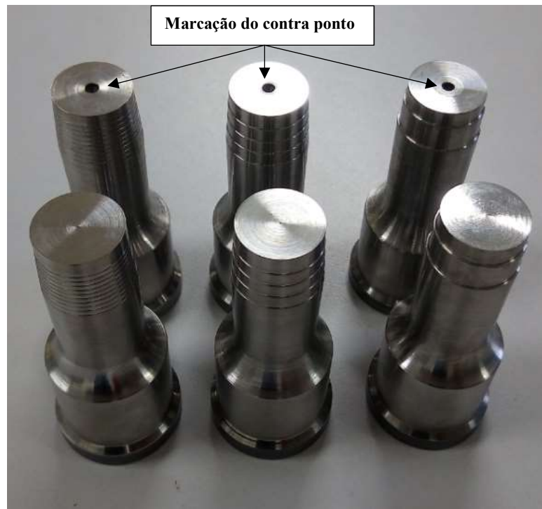
Figura 35 - Marcação com contra ponto.
