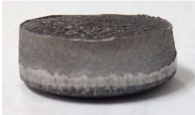
Figura 6 - Forma cônica dos retalhos no punçionamento de chapa de aço ASTM A-36 com espessura (s) 8 mm.
