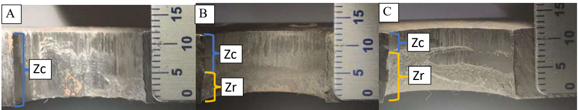
Figura 64 - Zona cisalhada (Zc) e Zona de ruptura Abrupta (Zr) A) Folga (w) 3,1%; B) Folga (w) 7,8%; C) Folga (w) 15,7%
