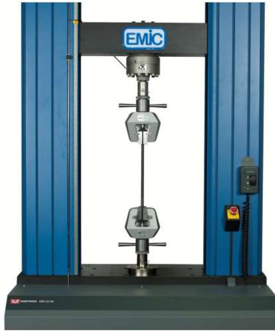
Figura 28 - Máquina EMIC utilizada no ensaio
