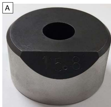
Figura 15 - Matriz de corte, a) vista isométrica, b) vista inferior e c) vista superior
