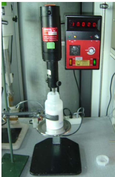
Figura 4.2. Mistura dos constituintes da barbotina por agitação mecânica de alta velocidade.
