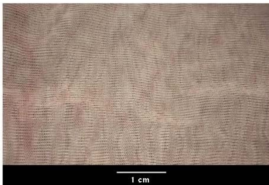
Figura 5.29. Tecido produzido com as fibras de poliamida 6 de 0,1 mm de diâmetro com revestimento composto de poliuretano/alumina.
