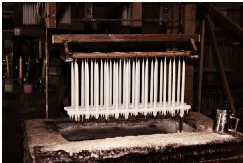
Figura 3.1. Processo artesanal de produção de velas baseado na técnica do dip coating . (Adaptado de 27 ).
