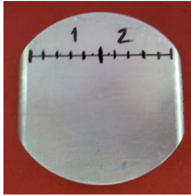
Figura 4.10. Porta-amostras e as respectivas marcações utilizadas para estimar as regiões danificadas ou não de cada fibra submetida ao teste de fricção
