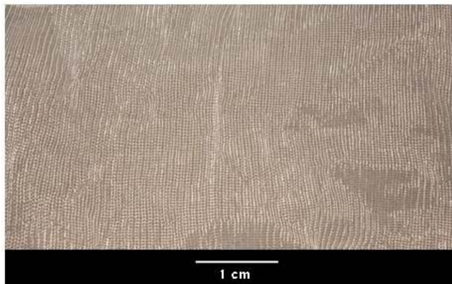
Figura 5.28. Tecido produzido com as fibras de poliamida 6 de 0,1 mm de diâmetro sem revestimento.
