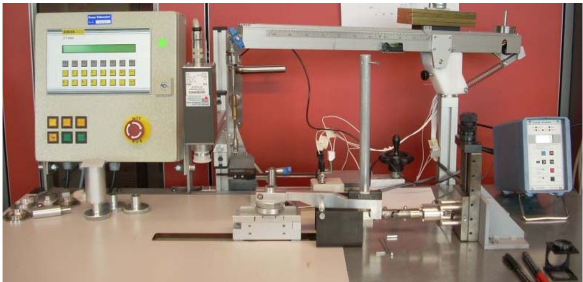
Figura 4.7. Equipamento utilizado para o ensaio de fricção sobre as fibras.
