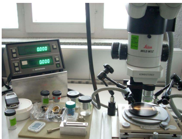
Figura 4.6. Microscópio óptico e micrômetro digital acoplado.
