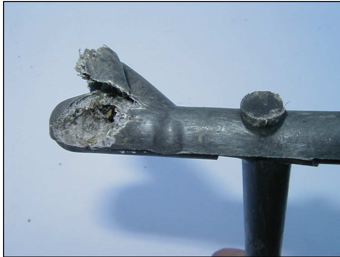
Figura 4.6: Estrutura interna porosa da peça
