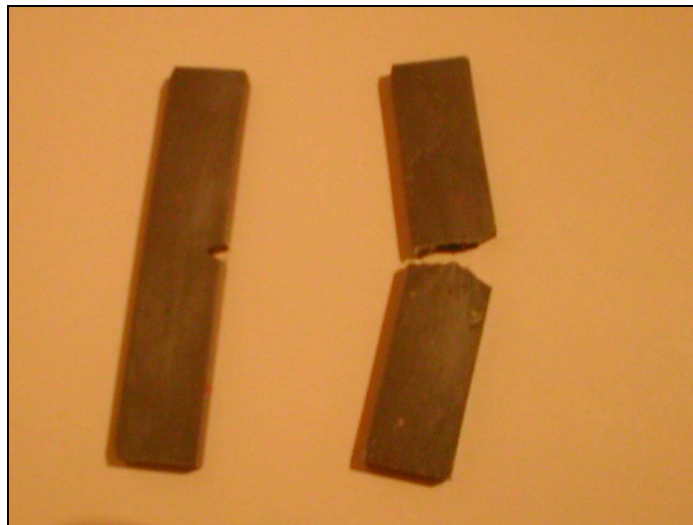
Figura 3.13: Corpos-de-prova para Izod antes e após o teste.
