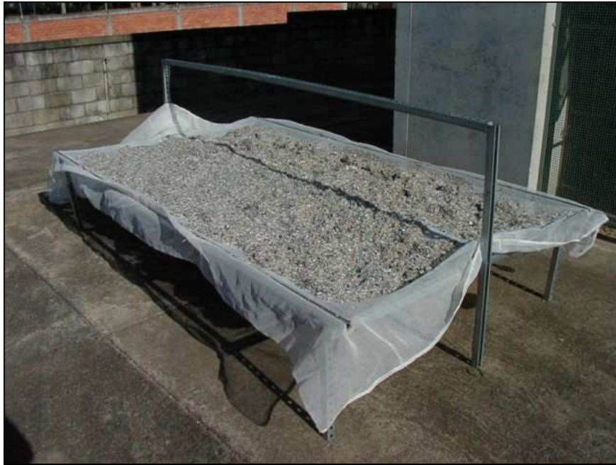
Figura 3.9: Secagem do material em estrutura de aço inoxidável.
