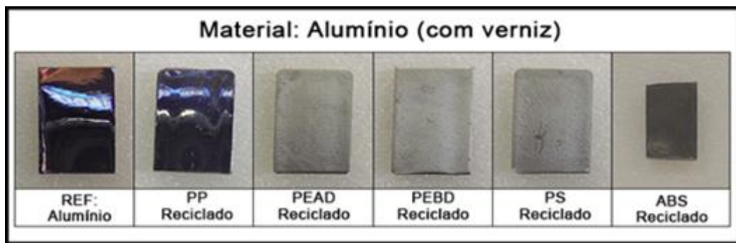
Figura 68 – Amostras metalizadas com alumínio (materiais reciclados)
