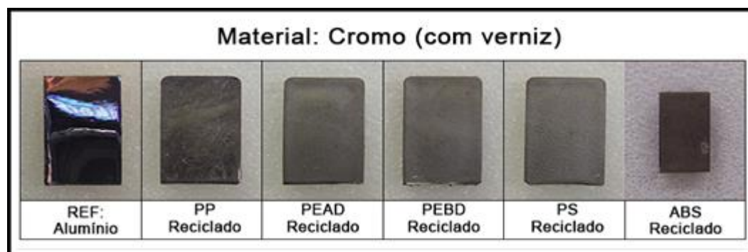
Figura 66 – Amostras metalizadas com cromo (materiais reciclados)
