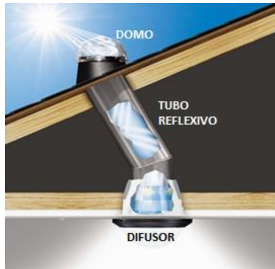
Figura 26 – Sistema de iluminação natural tubular
