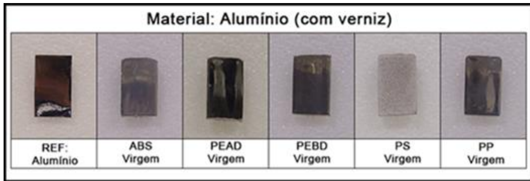
Figura 67 – Amostras metalizadas com alumínio (materiais virgens)
