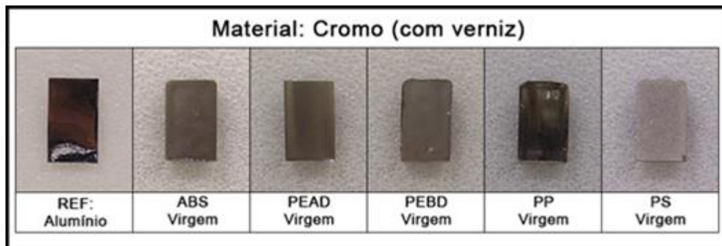
Figura 65 – Amostras metalizadas com cromo (materiais virgens)
