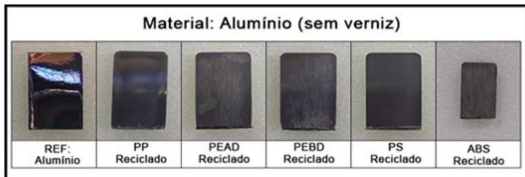
Figura 60 – Amostras metalizadas com alumínio (materiais reciclados)
