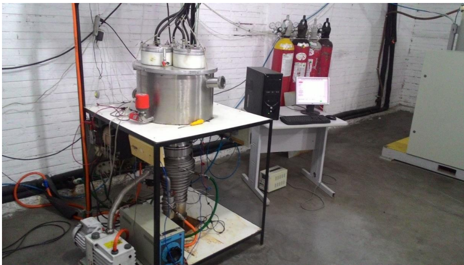
Figura 42 – Equipamento para metalização a vácuo (projeção catódica)
