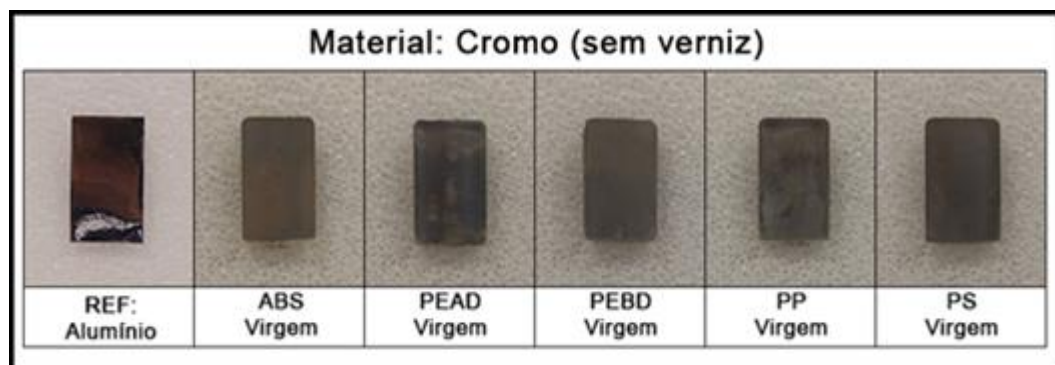
Figura 57 – Amostras metalizadas com cromo (materiais virgens)
