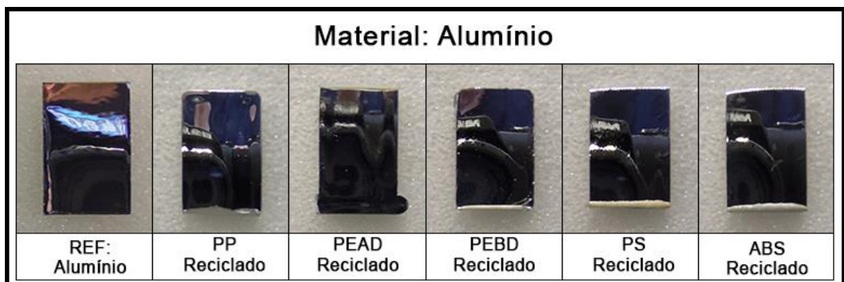
Figura 74 – Amostras metalizadas com alumínio (materiais reciclados)
