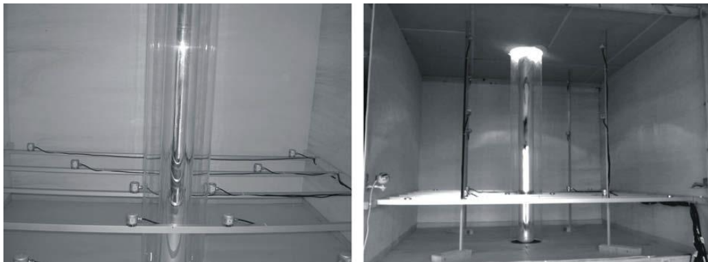
Figura 30 – Sistema proposto de iluminação por tubo duplo
