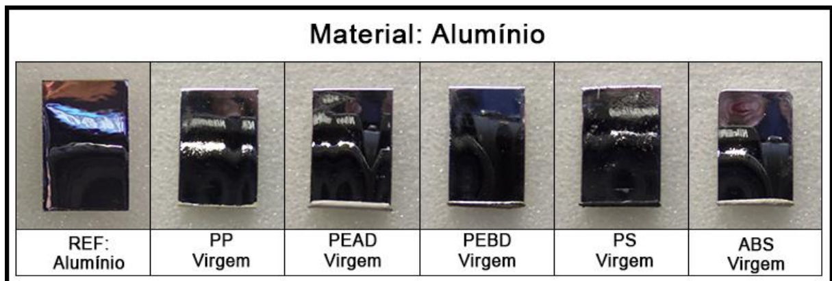
Figura 73 – Amostras metalizadas com alumínio (materiais virgens)
