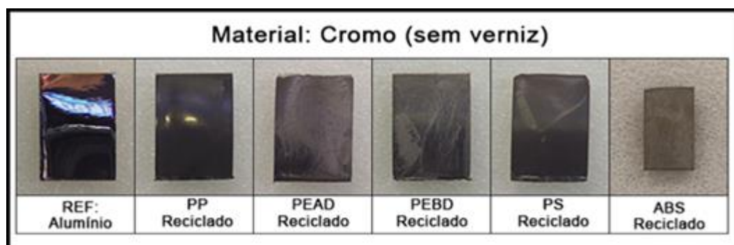
Figura 58 – Amostras metalizadas com cromo (materiais reciclados)
