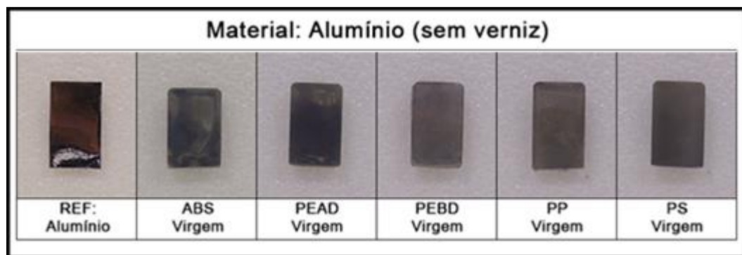
Figura 59 – Amostras metalizadas com alumínio (materiais virgens)
