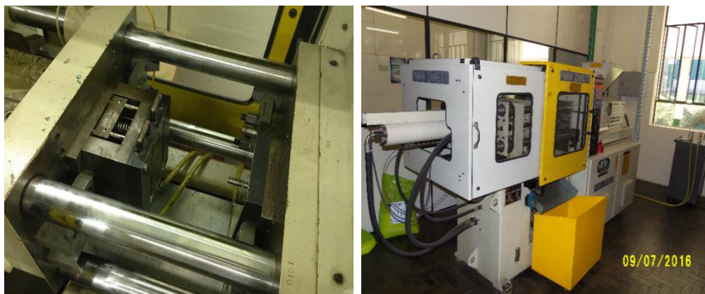
Figura 46 – Injetora PAVAN ZANETTI modelo NFN 150P com a matriz produzida
