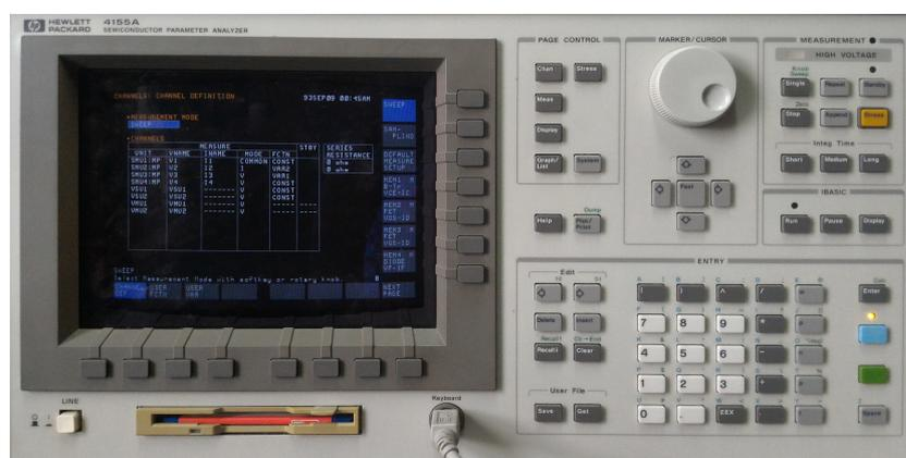
Figura 13 – Equipamento para medição de corrente de dreno. Fonte: autor.
