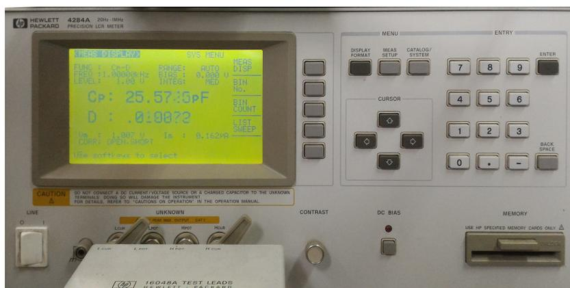
Figura 11 – Equipamento para medição de capacitância por tensão. Fonte: autor.
