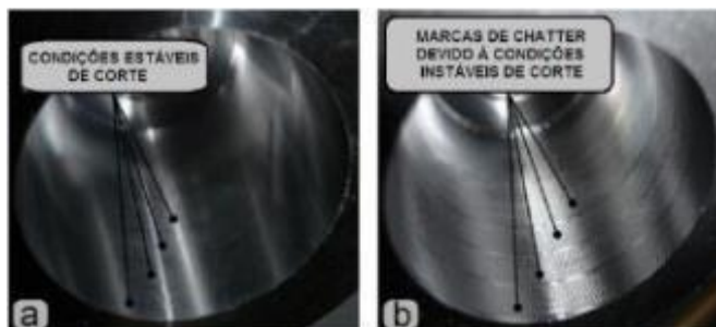
Figura 2.2 - Acabamento deteriorado pela ocorrência de “chatter” (Adaptado de Sortino et al., 2012)
