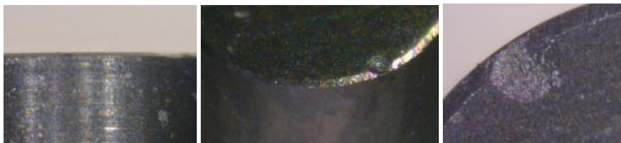
(a) (b) (c) Figura C.4 - Aresta 5, desgaste de cratera, após usinar 1 peça.
