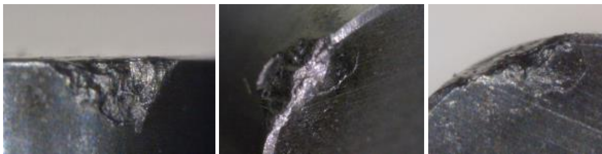
(a) (b) (c) Figura C.5 - Aresta 6, lascamento e microlascamentos após usinar 10 peças.
