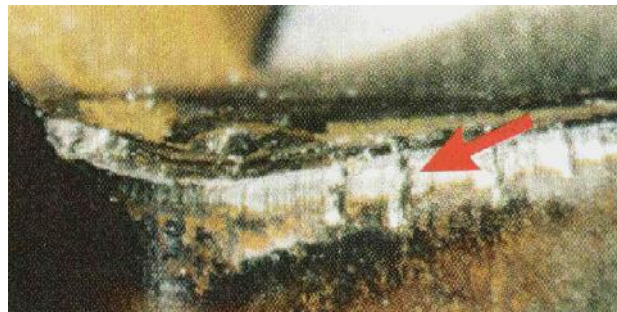
Figura A.2 - Trincas de origem térmica, perpendiculares a aresta de corte (Sandvik Coromant, 1999).
