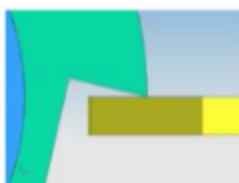
Figura 2.4 - Representação esquemática do início do contato no corte interrompido com peça predominantemente cilíndrica contendo rasgos de chaveta (Adaptado de Sanchez, 2011).
