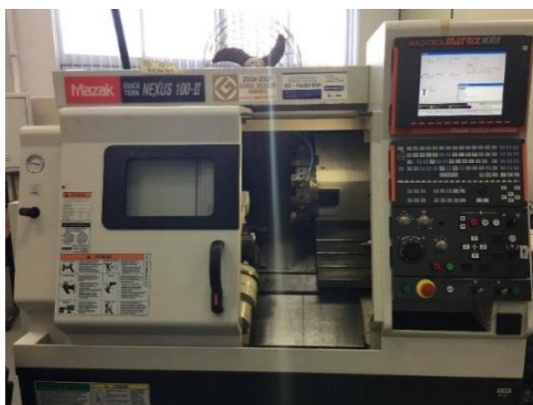
Figura 4.1 – Torno CNC Mazak QTN 100-II.
