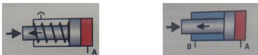
Figura 2.2: Representação do cilindro de dupla ação do tipo diferencial e do cilindro de simples ação com retorno por mola. Fonte: Exner, H. et al, 2002.
