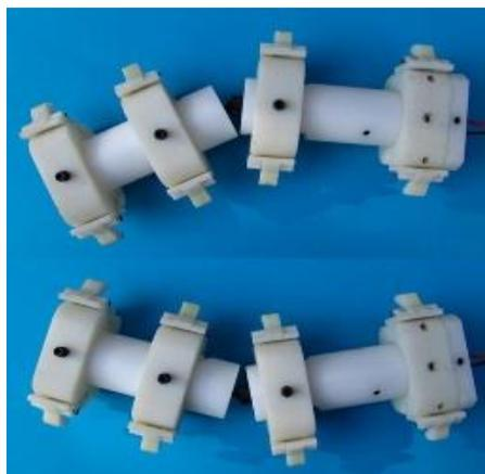
Figura 3.2: Protótipos de robô inchworm feito em uma impressora 3D deslocando-se em uma tubulação.
