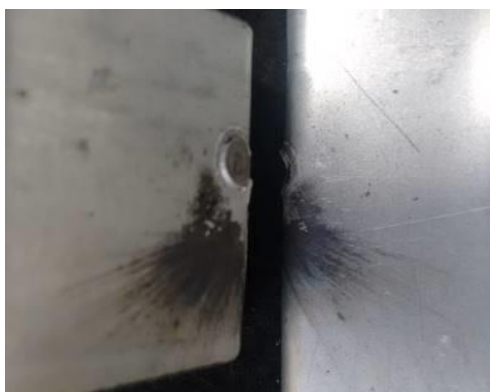
Figura 4.3: Corpo de prova 1-a após o ensaio de arrancamento
