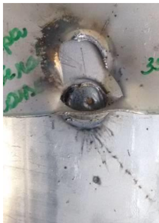
Figura 4.4: Corpo de prova 2-b após o ensaio de cisalhamento
