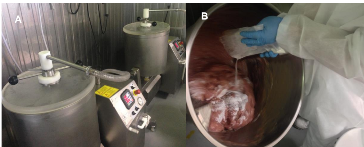
Figura 5. A – Tumbler Güther GPA 90 0,8W utilizado no processo para homogeneização da emulsão cárnea. B- Adição da Nisina diretamente na emulsão cárnea no tangleamento (fotos cedidas pela DuPont Esteio/RS 2015).
