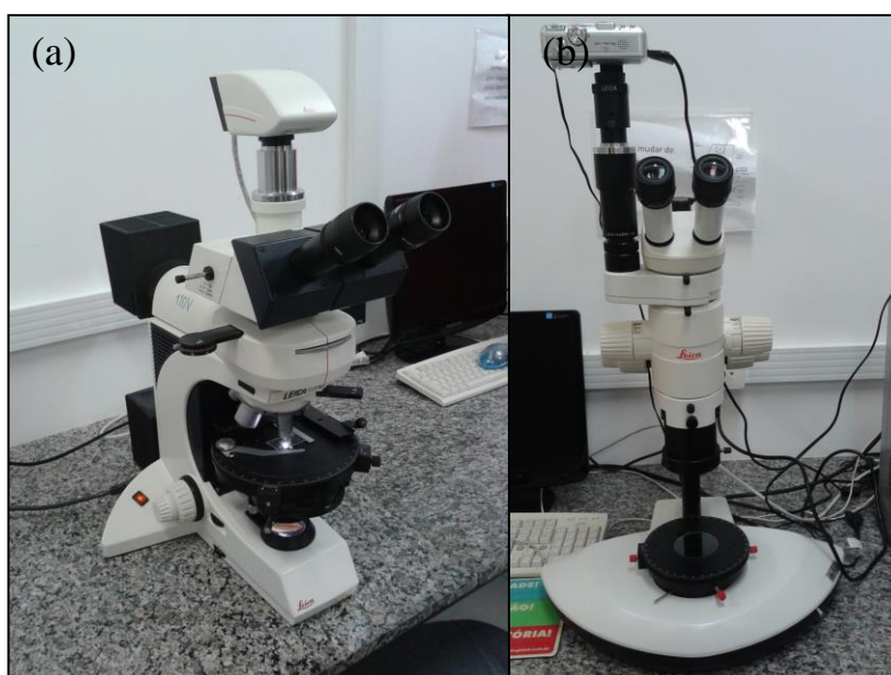
Figura 15. (a) Microscópio petrográfico LeicaDMLP ; (b) lupa binocular Leica MZI25 .
