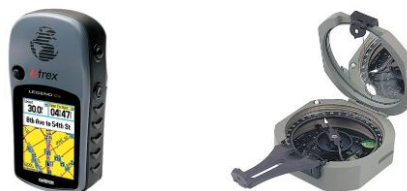
Figura 9. GPS Garmin Etrex Legend e bússola Brunton Pocket Transit usados na etapa de campo.
