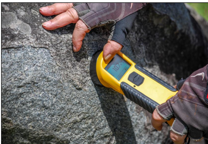
Figura 10. Tomada de medidas de susceptibilidade magnética na rocha durante a etapa de campo.
