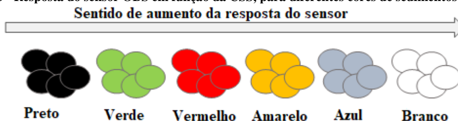
Figura 6 - Resposta do sensor OBS em função da CSS, para diferentes cores de sedimentos suspensos
