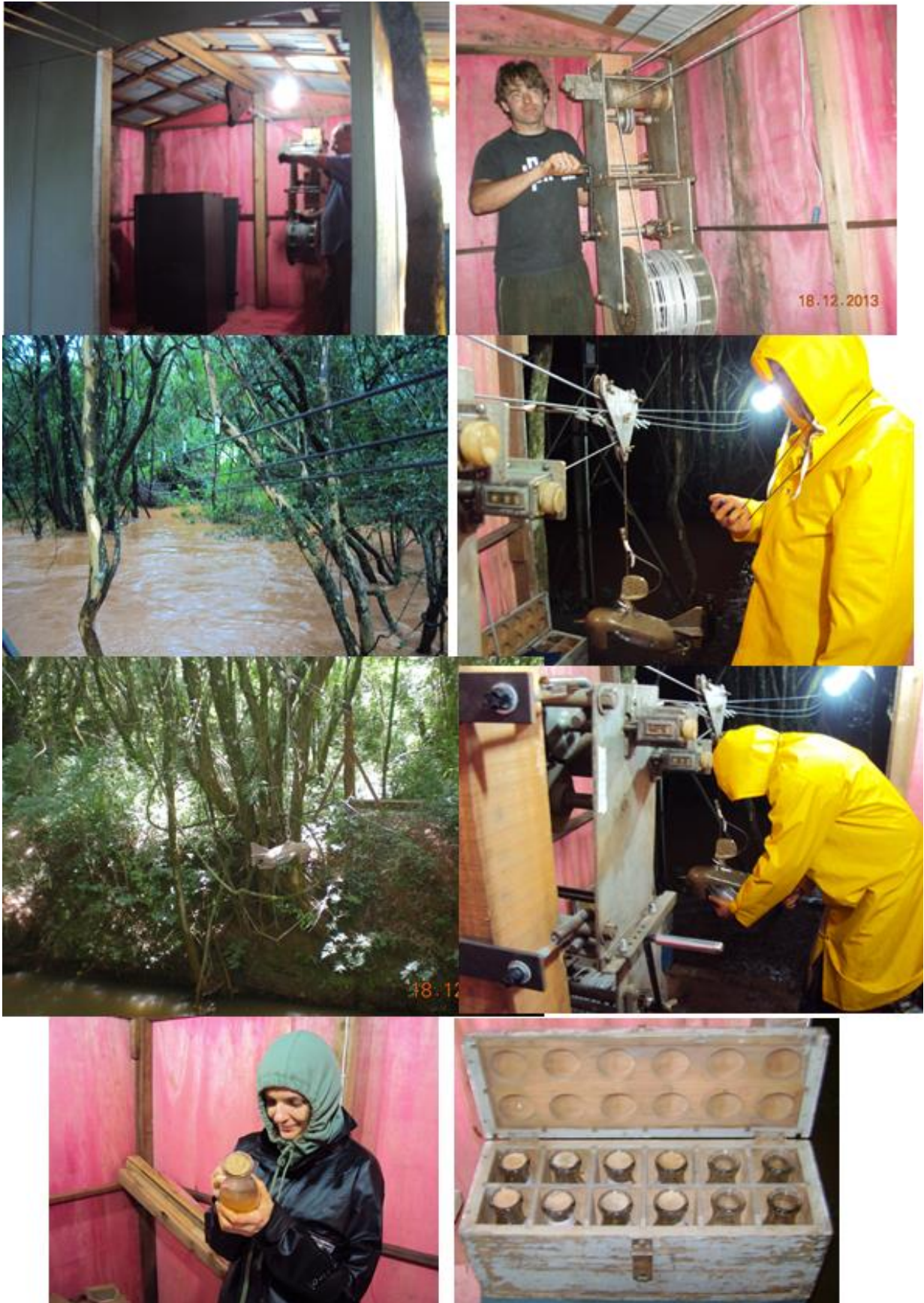
Figura 16 - Sistema de guincho instalado na bacia do Taboão para coleta de amostras água-sedimento e monitoramento da vazão
