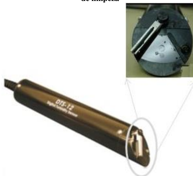
Figura 15 - Sensor de turbidez (DTS-12 SDI Turbidity Sensor) e no detalhe a superfície óptica e a lâmina de limpeza
