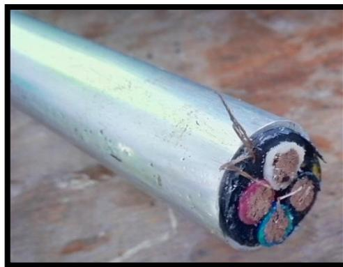
Figura 5.4 Cable revestido con capa de aluminio. [Fuente: Fotografía cedida por UFRGS 2016].
