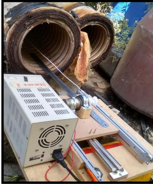
Figura 5.1 Sistema de movimiento para determinación de coeficiente de fricción en tuberías Riser. [Fuente: Fotografía cedida por UFRGS 2016].
