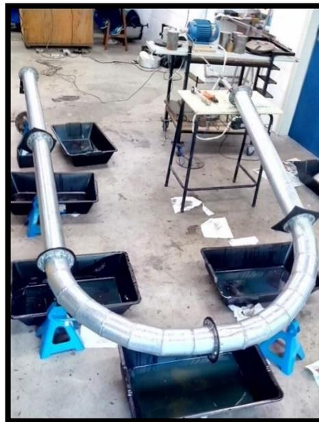
Figura 5.7 Instalación para la medición de fuerza de arrastre de cable, configuración en U.
