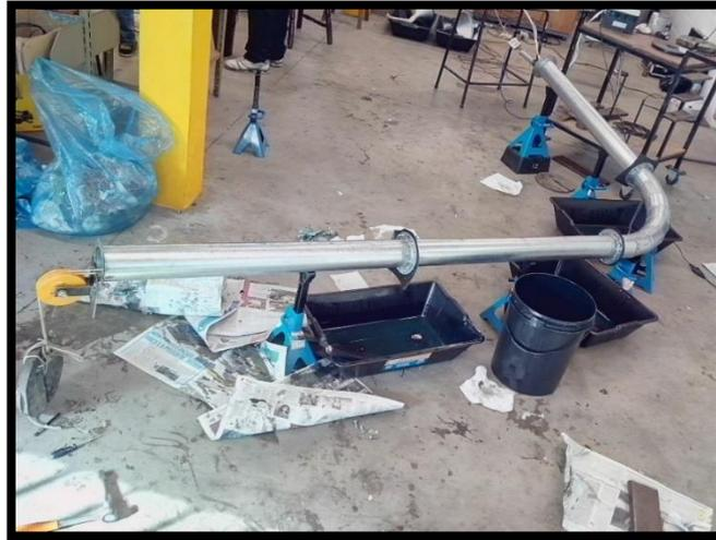
Figura 5.6 Instalación para la medición de fuerza de arrastre de cable, configuración en L.
