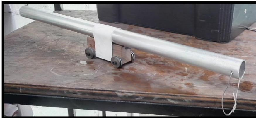
Figura 5.5 Cable con cubierta de aluminio montado carro de ruedas de acero. [Fuente: Fotografía cedida por UFRGS 2016].
