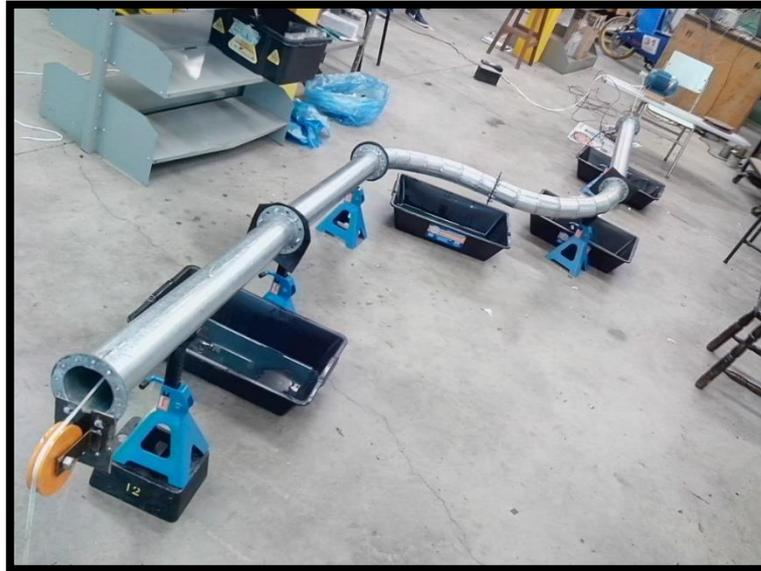
Figura 5.8 Instalación para la medición de fuerza de arrastre de cable, configuración en S. [Fuente: Fotografía cedida por UFRGS 2016].
