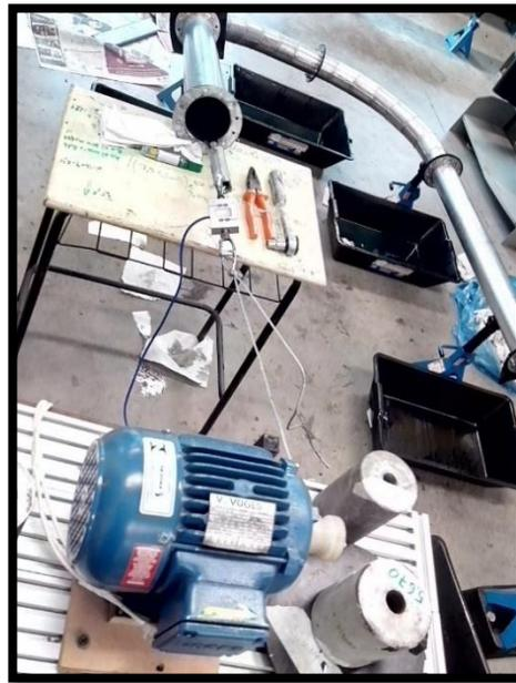
Figura 5.11 Detalle del sistema de tracción y medición de fuerza de arrastre de cable. [Fuente: Fotografía cedida por UFRGS 2016].
