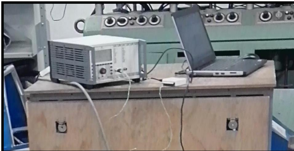
Figura 5.12 Puente de Wheatstone, la placa conversora y microcomputador utilizados para la medición de fuerzas. [Fuente: Fotografía cedida por UFRGS 2016].
