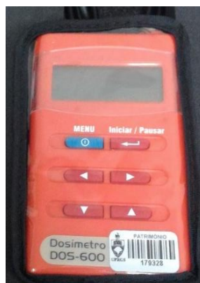
Figura 4.5 – Dosímetro DOS 600 utilizado para as medições de dose de ruído.
