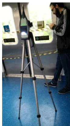
Figura 4.3 – Decibelímetros fixados em tripés, a 1,6m do piso, na linha central ao eixo longitudinal.
