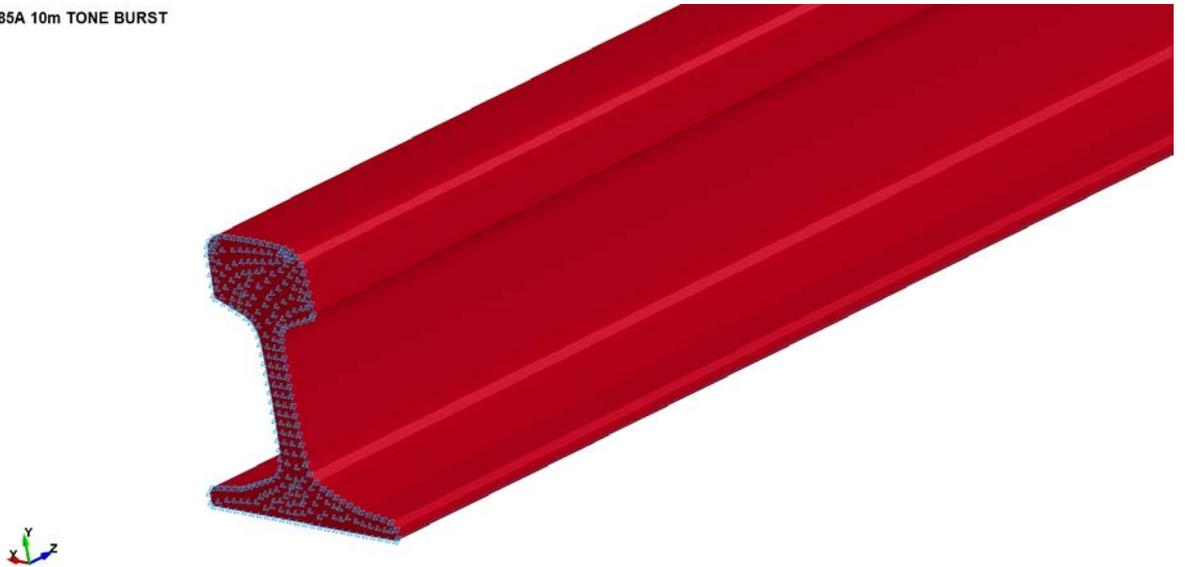
Figura 26 - Carga aplicada en la toda la sección del perfil.
