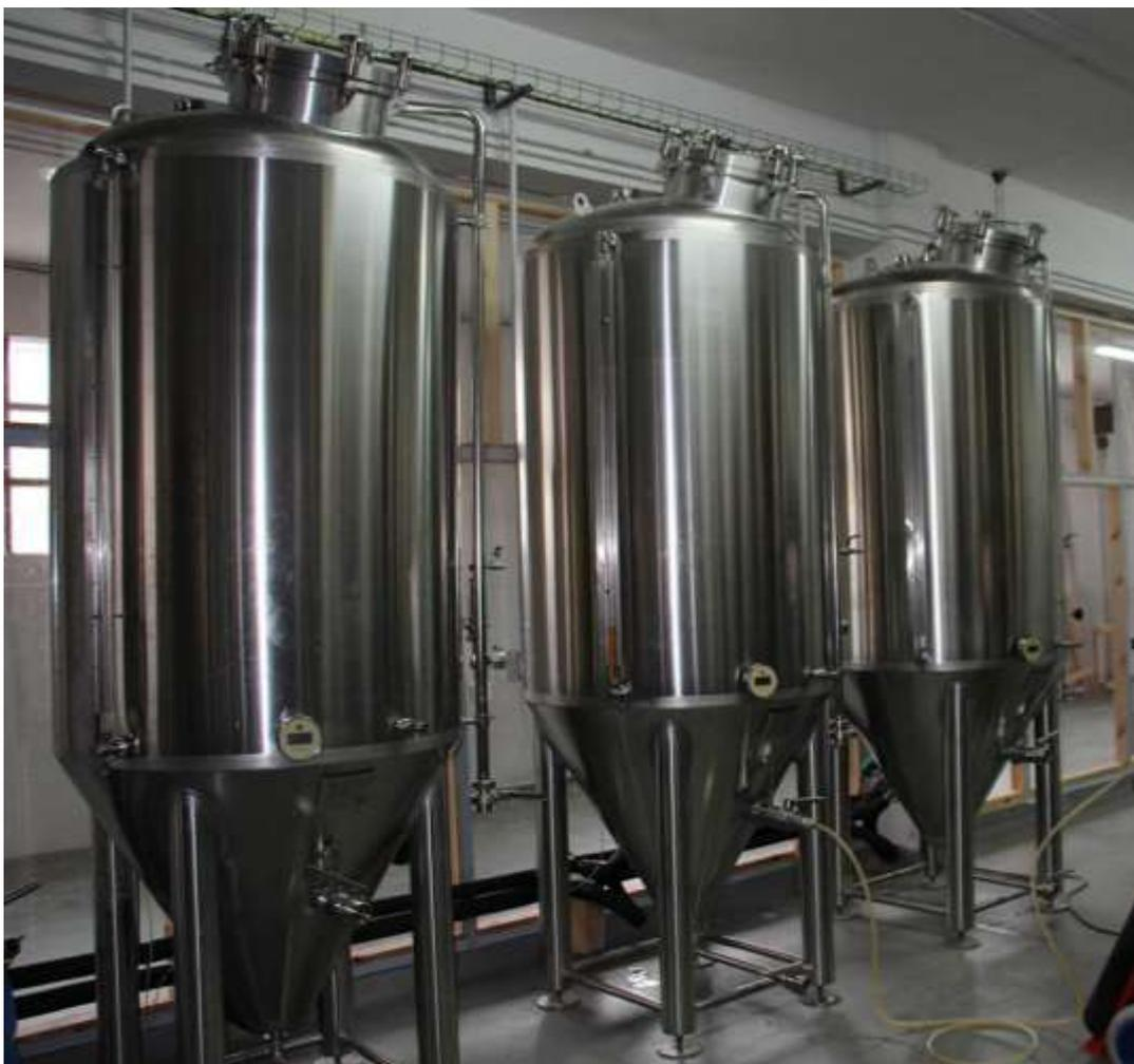
Figura 2.4 - Fermentadores Cilíndricos [Slowbeer, 2017].
