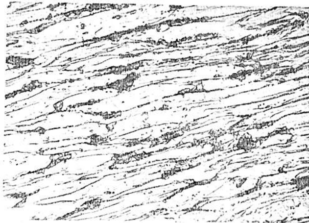
Fig. 7.5 - Arame com diâmetro 3,00 mm - Corte longitudinal Grãos claros de ferrita e grãos escuros de perlita Ataque: Nital 2% Aumento: 500 X
