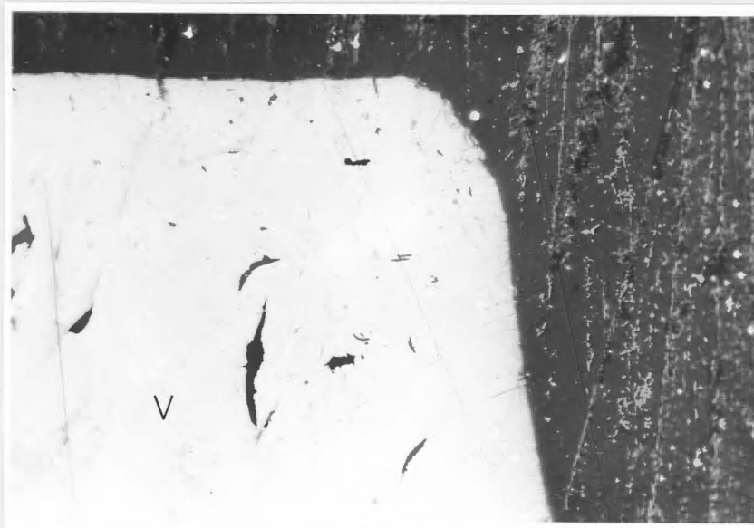
Foto 7 - Ciclone Convencional, fração -2+1,19 mm, tempo de ciclonação: 15 minutos, vitrinite (V) mostrando o padrão de quebra (cúbico).
