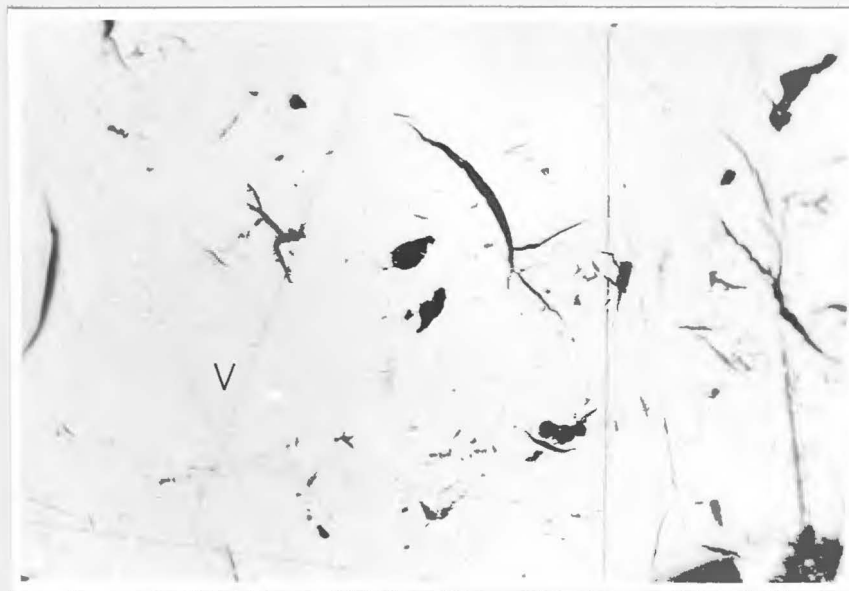
Foto 2 - Ciclone Convencional, fração -1,19+0,59 mm, tempo de ciclonação: 15 minutos, grão de vitrinite (V) praticamente isenta de impregnações de argila.
