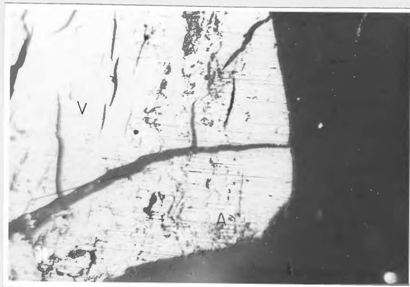
Foto 10 - Ciclone de Fundo Plano, fração -2+1,19 mm, tempo de ciclonagem: imediato, grão de vitrinite (V) com impregnações de argila (A), mostrando o processo de quebra, com mudança no padrão, de misto a angular.
