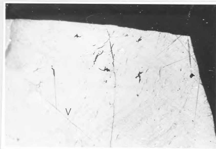
Foto 9 - Ciclone Convencional, fração -2+1, 19 mm, tempo de ciclonação: 15 minutos, grão de vitrineta mostrando o padrão forma (anguloso).
