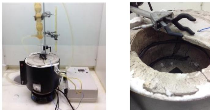
Figura 18: Forno e Controlador de Temperatura Utilizado na Polimerização.
