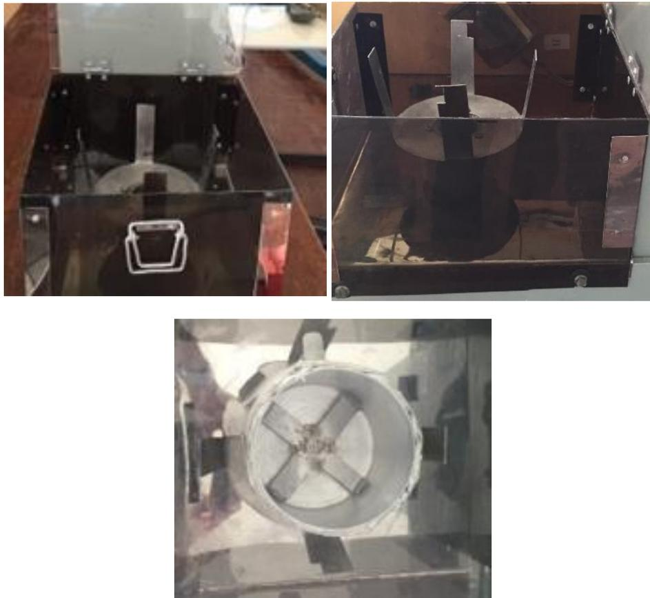
Figura 17: Misturador utilizado na preparação das amostras de PVC.
