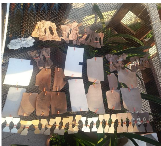
Figura 22: Imagens das amostras das bioblendas (PCL/PLA) e dos biocompósitos expostos ao intemperismo natural.
