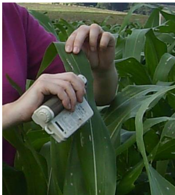
Foto 6. Leitura do teor relativo de clorofila na folha com o aparelho clorofilômetro.
