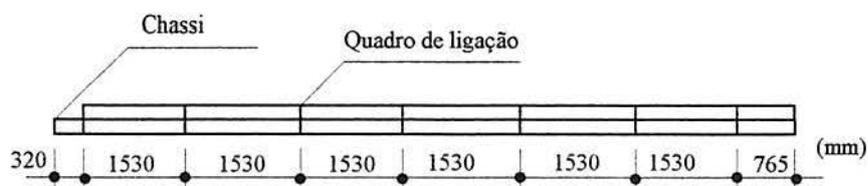
Figura (7.7) - Disposição dos quadros de ligação carroceria- chassi.
