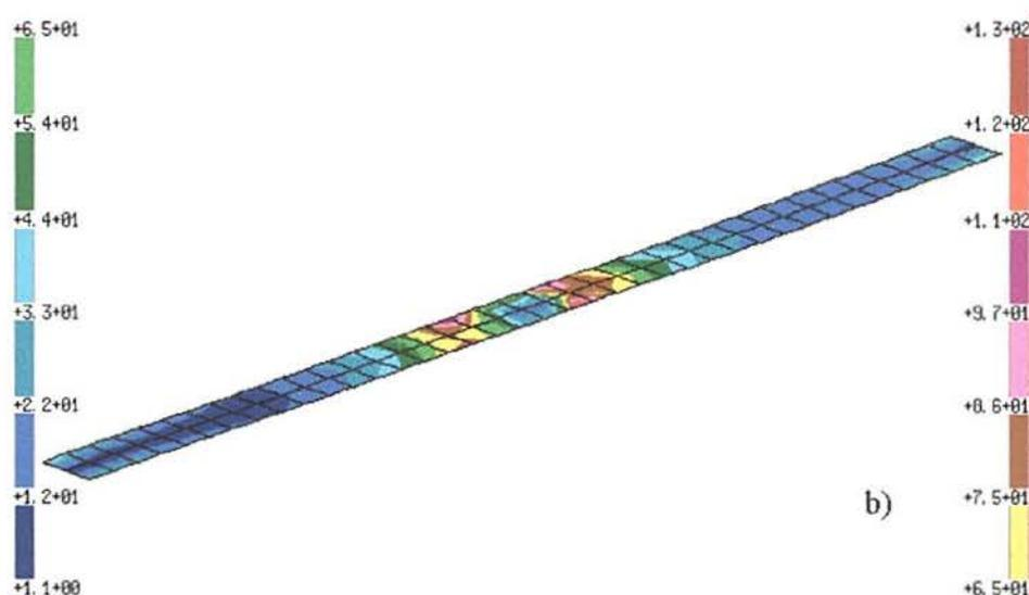
Figura (H.6) - Tensão de von Mises [MPa] na mesa superior do perfil C – figura (H.3.d).
