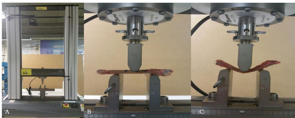
Figura 2: A) máquina de ensaios Instron modelo 3369. B) ulna contralateral posicionada no teste de três pontos. C) momento de flexão.
