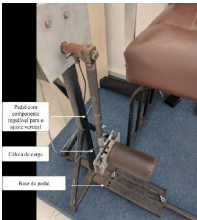
Figura 15 - Detalhes do pedal (MEEREIS, 2012).
