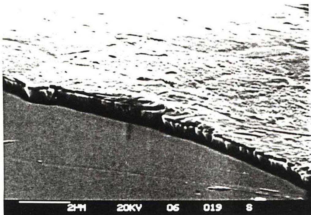
Figura 37 - Microfotografia de um filme de PAN formado por 10 minutos a 0,9V sobre eletrodo de Pt em meio \text{H}_2\text{SO}_2 2M + 5-amino 1-naftol 10^{-3} M.
