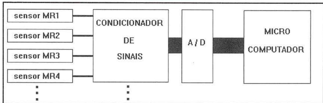
Fig. 6.18 - Diagrama em blocos do sistema.
