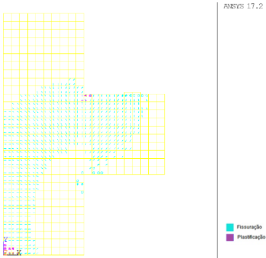
Figura 31 - Ruptura do consolo projetado
