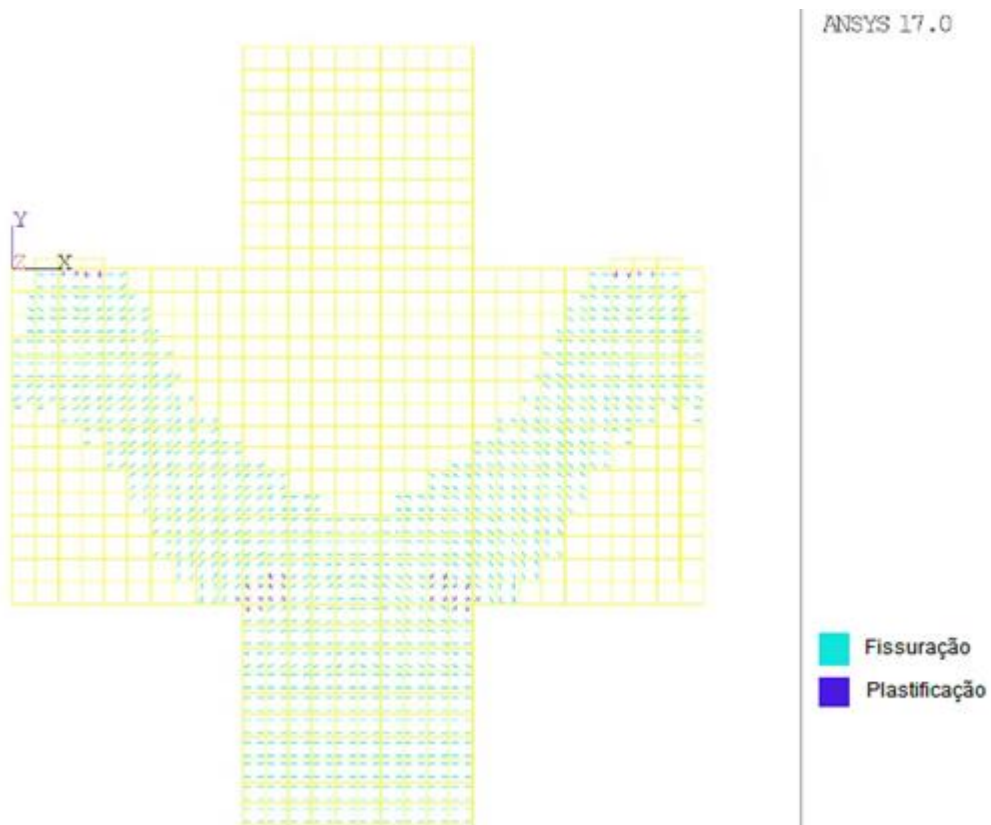
Figura 25 - Fissuração e plastificação do consolo experimental
